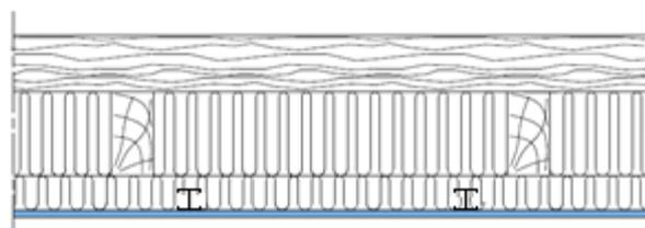
Lames d'air : cas avec isolant.
