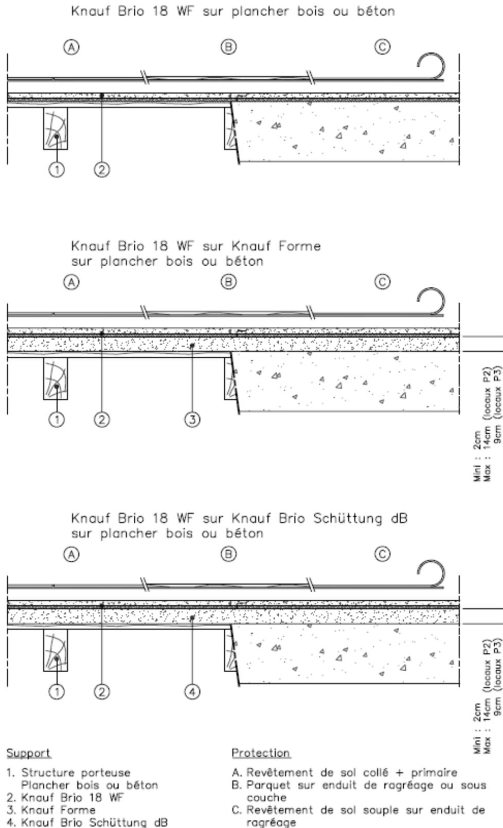
**Figure 3 – Mise en œuvre Knauf Brio 18 WF**
