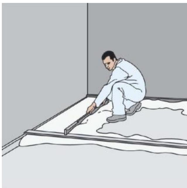
**Figure 4 - mise en œuvre des granulats d'égalisation**
