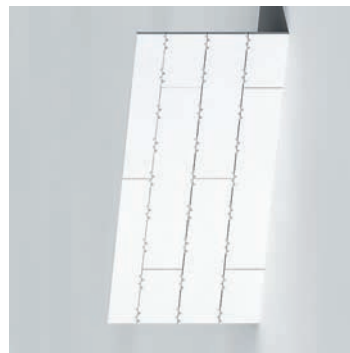
Fig. 22 : Plan de pose des clips FIB IV (5 FIB IV/m 2 )
