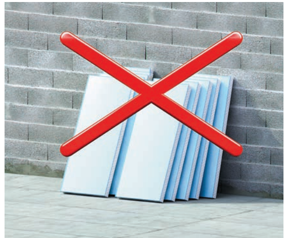
Fig. 28 : Stockage des panneaux à plat
