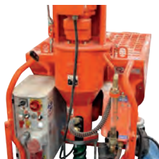
Machine tractable à projeter du plâtre, Knauf Vermiplaster®, de type PFT G4
