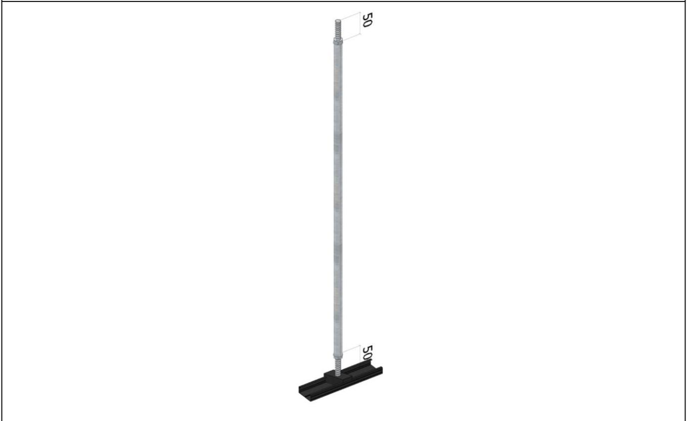
**Figure 3 - Plafond extérieur Hydrodroof\_suspente pivot avec tube (butonnage)**
