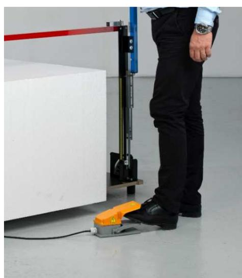
Possibilité de commande de la mise en chauffe du fil de découpe par une pédale à pied
