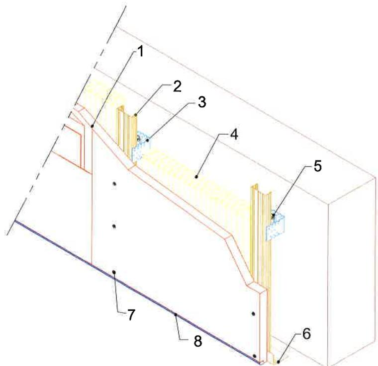
**Figure 6 - Contre cloisons : DH 118 / Diamant 15 – Contre cloison suspente U et fourrures**
