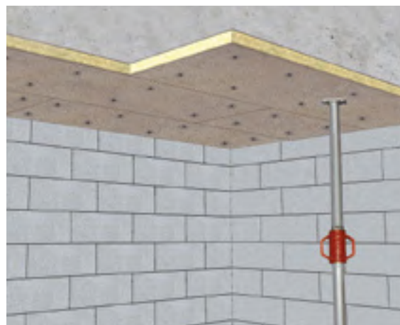
Fig. 14 : Mise en place et fixation des panneaux
