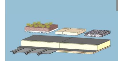
Isolant support d'étanchéité sous protection lourde
