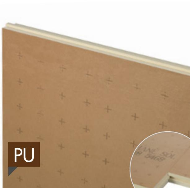
Knauf Thane Sol est un panneau composé d'une âme en mousse rigide de polyuréthane et de deux parements composites résistant à l'humidité, conforme à la norme NF EN 13165. Il est destiné à l'isolation des dallages sur terre-plein selon le DTU 13.3 et des dallages de locaux et bâtiments frigorifiques selon le DTU 45.1.
