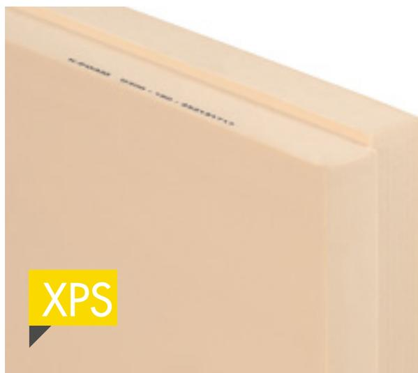
K-FOAM C500 F4 est un panneau en polystyrène extrudé de couleur orange avec peau de surface et bords feuillurés sur les 4 côtés conforme à la norme NF EN 13164. Il est destiné à l'isolation des planchers sous dallage sur terre-plein selon le DTU 13.3, des dallages de locaux et bâtiments frigorifiques selon le DTU 45.1 et des radiers selon les règles de l'art.
