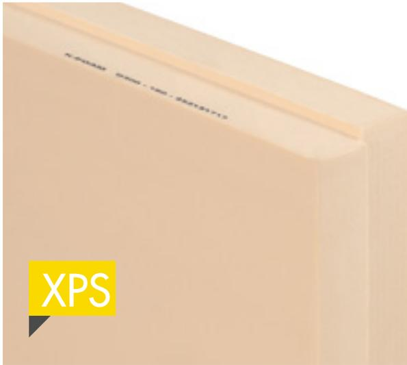
K-FOAM D300 F4 est un panneau en polystyrène extrudé de couleur orange avec peau de surface, conforme à la norme NF EN 13164. Il est destiné à l'isolation des planchers sous dallage sur terre-plein selon le DTU 13.3 et des dallages de locaux et bâtiments frigorifiques selon le DTU 45.1.
