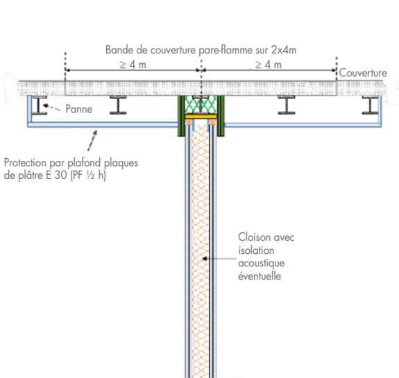
Installer de part et d'autre de la cloison un plafond plaques de plâtre d'au moins 4 m de large, en matériaux incombustibles ou A1 et de degré pare-flamme 1/2 h au moins et ne comportant aucune ouverture. Le plafond pare-flamme remplace l'encoffrement des pannes.
