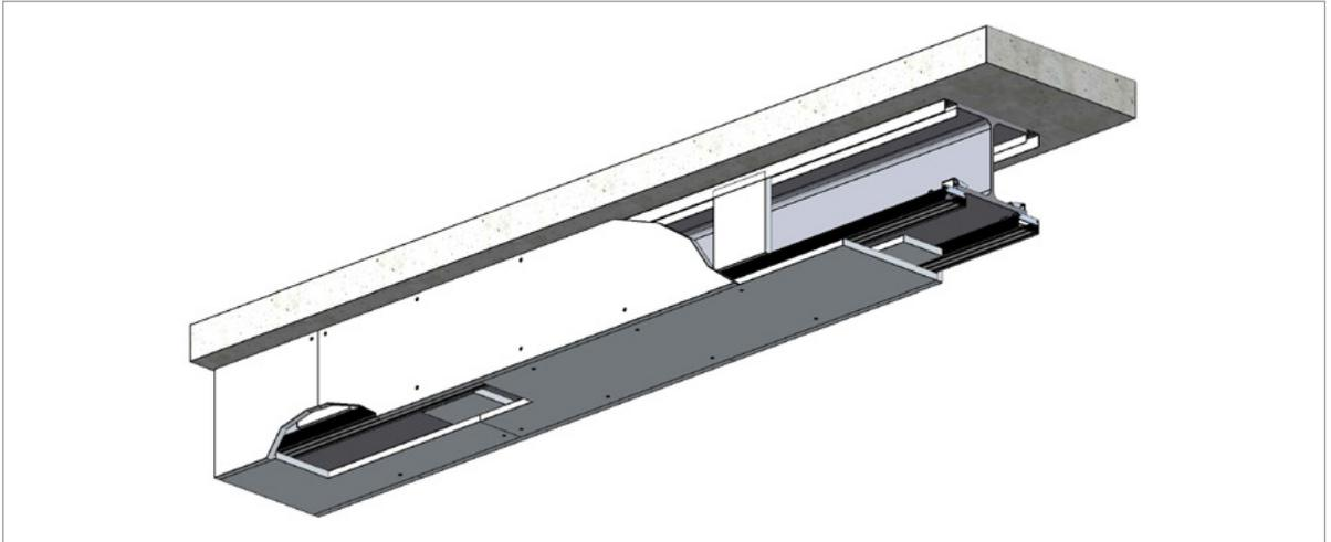
La protection des structures est réalisée par un habillage, sur 3 ou 4 faces, mis en œuvre directement autour de la structure à protéger. Ces caissons sont composés d'un parement simple, double ou triple en combinant éventuellement les différentes épaisseurs en fonction du facteur de massivité du profilé à protéger et de la durée de protection requise (voir tableau ci-après).
