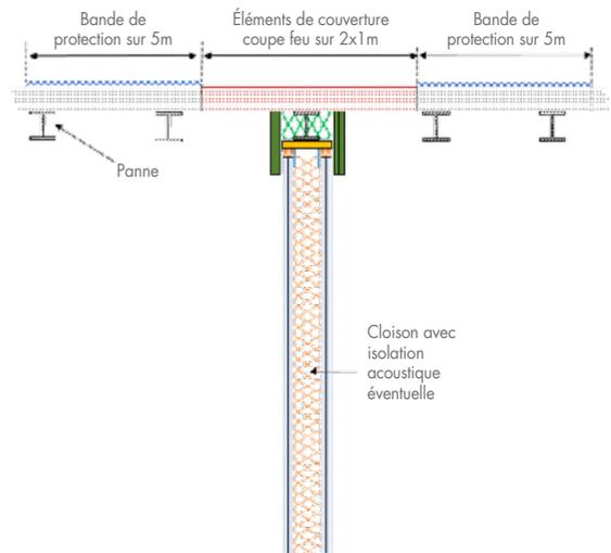
En toiture (fig. 2) : mettre en œuvre de chaque côté de la cloison des éléments de couverture coupe-feu de degré 2 h sur une largeur minimale de 1 m et recouvrir la couverture d'une bande de protection (feuille métallique, gravillons) sur une largeur de 5 m minimum.
