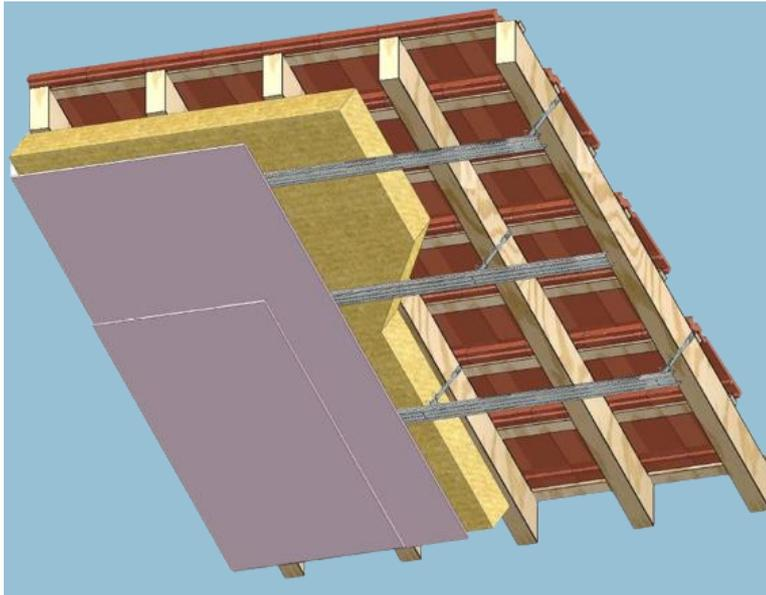
Plafond rampant sur ossature métallique
