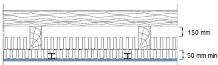
Lames d'air : cas avec isolant.
