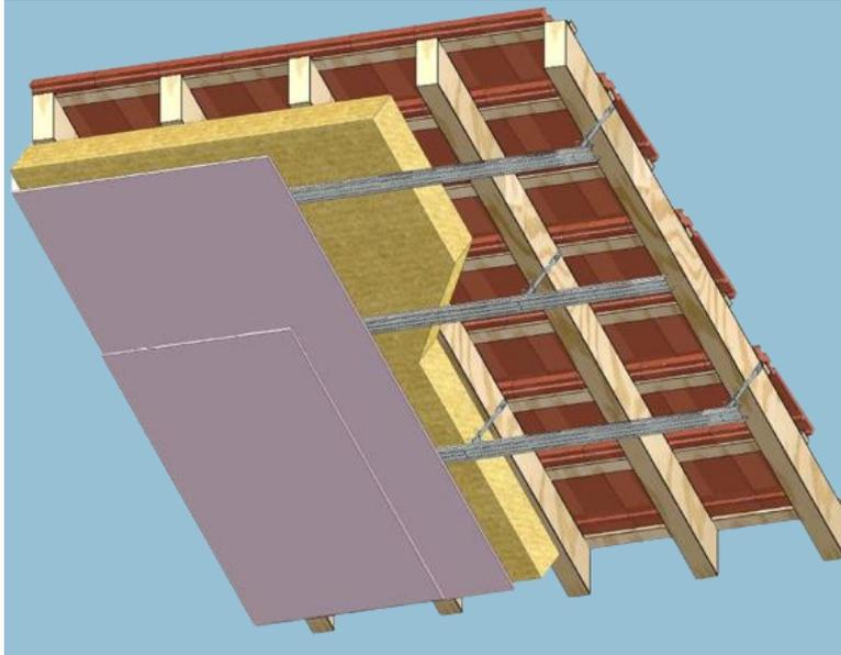
Plafond rampant sur ossature métallique
