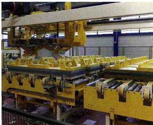
Une fois le complexe sandwich réalisé, les panneaux suivent un circuit dynamique durant lequel ils vont être contraints par une gueuse le temps que la colle se polymérise. A l'issue de ce circuit chronométré, le produit subit un dernier usinage sur ses différentes parois et est prêt à être palettisé.
