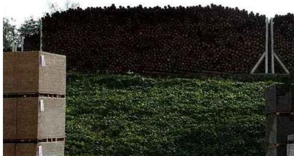
Les rondins de résineux sont tenus en stock six mois sur site et chez les fournisseurs de Knauf Fibre. Ce volume d'environ 12 000 stères permet d'approvisionner les deux lignes de convoyeurs du fabricant à longueur de journée. Il faut noter qu'il s'agit de bois de sciage sélectionné avec peu ou pas de défauts pour obtenir au final une fibre apparente impeccable.
