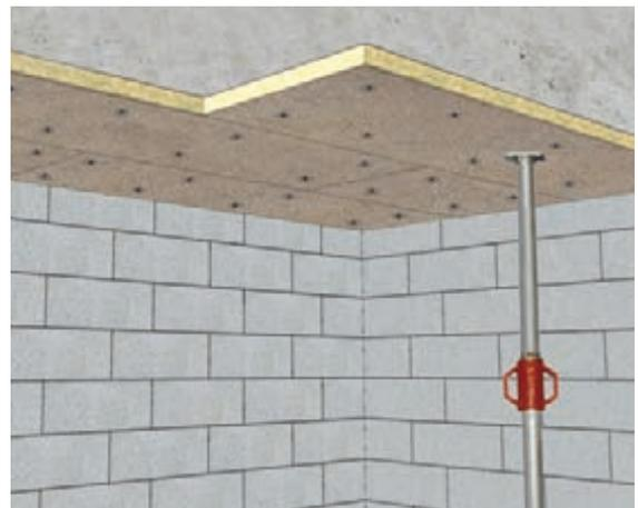
Fig. 14 : Mise en place et fixation des panneaux
