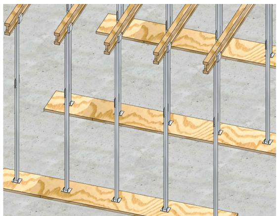
Fig. 4 : Mise à niveau des poutrelles
