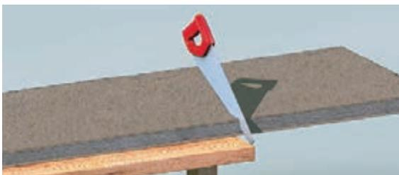
Fig. 19 : Découpe sur support plan
