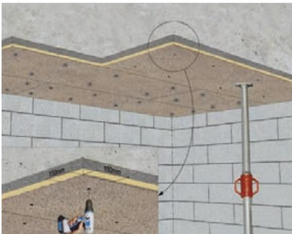
Fig. 13 : Fixation mécanique directe
