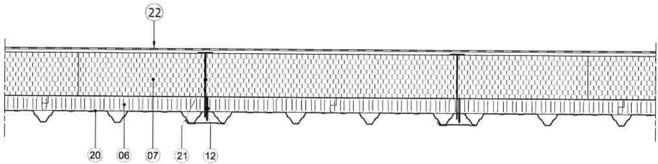
Chaque panneau Fesco C-DO est fixé <sup>(12)</sup> dans chaque « nervure caisson » de la tôle d'acier nervurée <sup>(20)</sup>,
