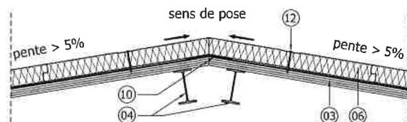
**Figure 3d – Raccordement des panneaux Fesco C-DO en faîtage et arêtier - Appuis doubles**
