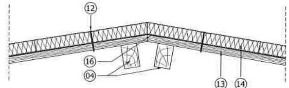
**Figure 18d – Raccordement des panneaux Fesco C en faitage et arêtier - Appuis doubles**
