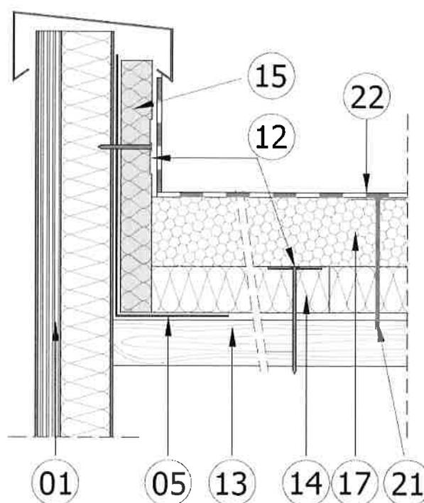
L'aile horizontale de la costière métallique<sup>(05)</sup> est fixée dans l'élément porteur selon le NF DTU 43.4 P1.
