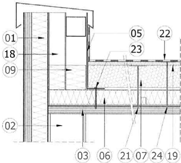
L'espace situé entre la costière métallique et la paroi verticale est comblé par le panneau Fesco C-DO <sup>(06)</sup> prolongé jusqu'à l'extrémité de l'élément porteur <sup>(03)</sup> ; en complément, cet espace peut être comblé jusqu'au niveau supérieur du panneau et en Fesco C ou Fesco C-S <sup>(19)</sup> par un isolant <sup>(09)</sup> de classe A2-s2,d0 au moins.
