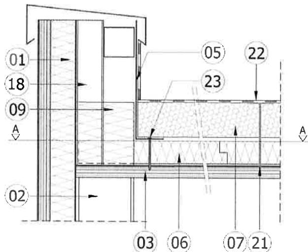
L'espace situé entre la costière métallique et la paroi verticale est comblé par le panneau Fesco C-DO<sup>(06)</sup> prolongé jusqu'à l'extrémité de l'élément porteur<sup>(03)</sup> ; en complément, cet espace peut être comblé jusqu'au niveau supérieur du panneau KNAUF Therm TTI Se<sup>(07)</sup> par un isolant<sup>(09)</sup> de classe minimale A2-s2,d0.
