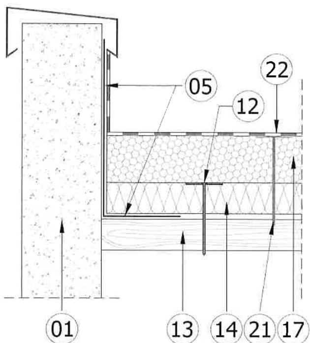
L'aile horizontale de la costière métallique<sup>(05)</sup> est fixée dans l'élément porteur selon le NF DTU 43.4 P1.
