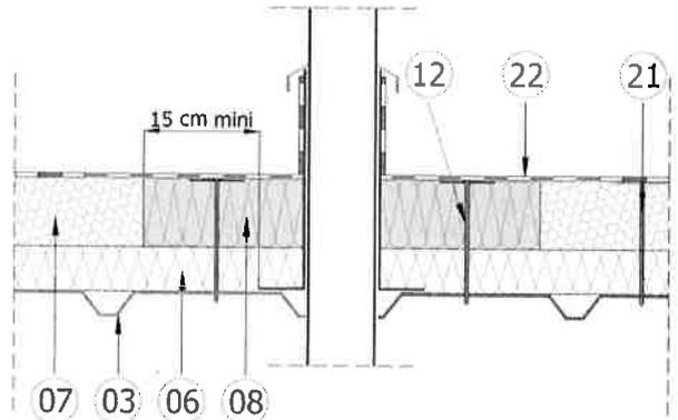
Le calfeutrement autour du fourreau de conduit ou gaine métallique traversant la toiture est réalisée par un panneau de la Gamme Fesco® non revêtu<sup>(08)</sup> d'épaisseur égale à celle du lit supérieur en panneau KNAUF Therm TTI Se<sup>(07)</sup> et découpé sur une largeur dépassant de 15 cm au moins le bord de la platine ; il est placé au-dessus de l'écran thermique<sup>(06)</sup> et est fixé mécaniquement<sup>(12)</sup> dans l'élément porteur<sup>(03)</sup>.
