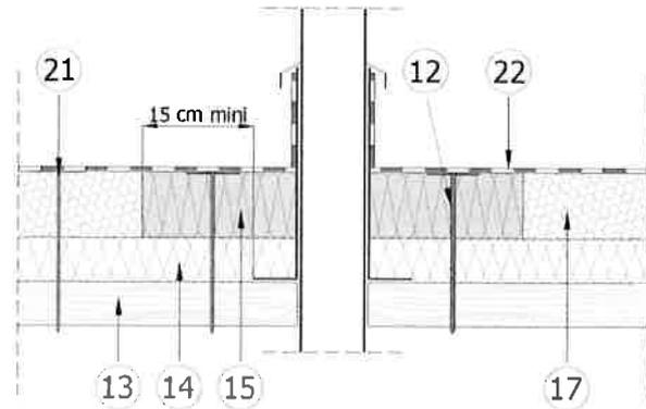
Le calfeutrement autour du fourreau de conduit ou gaine métallique traversant la toiture est réalisé par un panneau de la Gamme Fesco® non revêtu<sup>(15)</sup> d'épaisseur égale à celle du lit supérieur en panneau KNAUF Therm TTI Se<sup>(17)</sup> et découpé sur une largeur dépassant de 15 cm au moins le bord de la platine ; il est placé au-dessus de l'écran thermique<sup>(14)</sup> et est fixé mécaniquement<sup>(12)</sup> dans l'élément porteur<sup>(13)</sup>.
