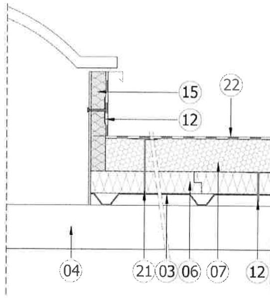
Le panneau vertical de la Gamme Fesco® non revêtu <sup>(15)</sup>, de résistance thermique déclarée minimale conforme à sa norme produit, est fixé mécaniquement <sup>(12)</sup> dans la costière métallique ou lanterneau ou exutoire.
