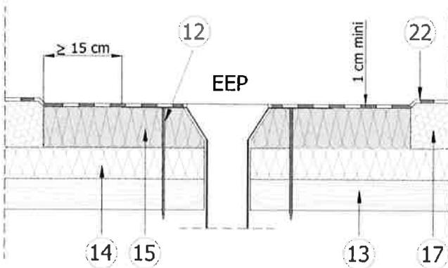
Le calfeutrement autour de l'évacuation d'eaux pluviales est réalisé par un panneau de la Gamme Fesco® non revêtu<sup>(15)</sup> d'épaisseur inférieure d'au moins 1 cm à celle du lit supérieur en panneau KNAUF Therm TTI Se<sup>(17)</sup> et découpé sur une largeur dépassant de 15 cm au moins le bord de la platine d'entrées d'eaux pluviales ; il est placé au-dessus de l'écran thermique<sup>(14)</sup> et est fixé mécaniquement<sup>(12)</sup> dans l'élément porteur<sup>(13)</sup>.
