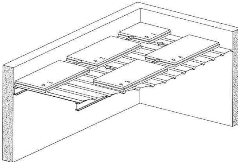
Les feuillures du 1<sup>er</sup> lit en panneaux Fesco C-DO sont découpées en angle, sur 2 côtés (P1) et en rives, sur un côté (P2, P3 et P4),
