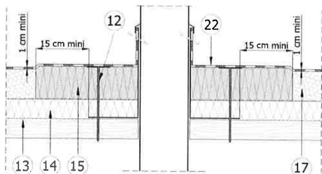
Le calfeutrement autour d'un conduit ou gaine métallique traversant la toiture est réalisé par un panneau de la Gamme Fesco® non revêtu<sup>(15)</sup> d'épaisseur supérieure d'au moins 1 cm à celle du lit supérieur en panneau KNAUF Therm TTI Se<sup>(17)</sup> et découpé sur une largeur dépassant de 15 cm au moins le bord de l'aile horizontale de la costière métallique<sup>(05)</sup> ;
