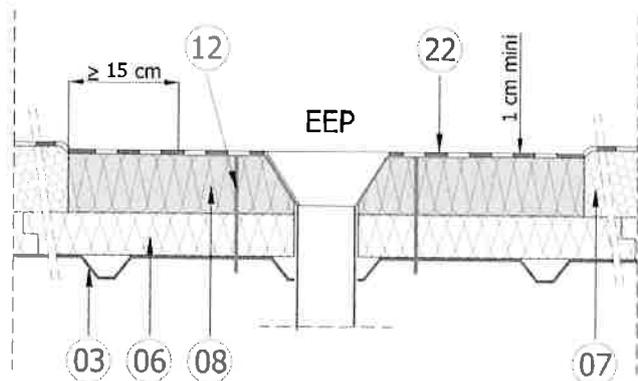
Le calfeutrement autour de l'entrée d'eaux pluviales est réalisé par un panneau de la Gamme Fesco® non revêtu<sup>(08)</sup> d'épaisseur inférieure d'au moins 1 cm à celle du lit supérieur en panneau KNAUF Therm TTI Se<sup>(07)</sup> et découpé sur une largeur dépassant de 15 cm au moins le bord de la platine d'entrée d'eaux pluviales ; il est placé au-dessus de l'écran thermique<sup>(06)</sup> et est fixé mécaniquement<sup>(12)</sup> dans l'élément porteur<sup>(03)</sup>.
