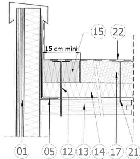
Le calefeutrement est réalisé par un panneau de la Gamme Fesco® non revêtu <sup>(15)</sup>, d'épaisseur égale à celle du lit supérieur en panneau KNAUF Therm TTI Se <sup>(17)</sup> et découpé sur une largeur minimale de 15 cm ; il est fixé mécaniquement à l'élément porteur <sup>(13)</sup> à raison d'une fixation <sup>(12)</sup> par panneau isolant. L'aile horizontale de la costière métallique <sup>(5)</sup> est fixée dans l'élément porteur <sup>(13)</sup> conformément au NF DTU 43.4 P1.
