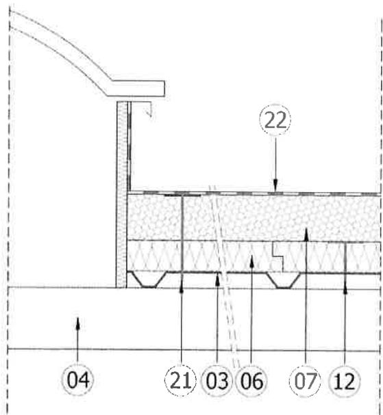
Le lit supérieur en panneau KNAUF Therm TTI Se <sup>(07)</sup> est en contact avec la costière pré-insulée.
