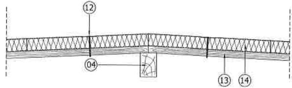
**Figure 18b – Raccordement des panneaux Fesco C en faitage et arêtier - Appui simple**
