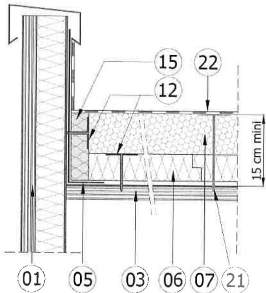
Le calfeutrement est réalisé par un panneau vertical de la Gamme Fesco® non revêtu<sup>(15)</sup> d'épaisseur minimale 50 mm, découpé sur une hauteur minimale de 15 cm et égale à l'épaisseur totale de l'écran thermique<sup>(06)</sup> plus celle du panneau KNAUF Therm TTI Se<sup>(07)</sup> ; il est fixé mécaniquement dans l'aile verticale de la costière métallique<sup>(05)</sup> à raison d'une fixation<sup>(12)</sup> par panneau.
