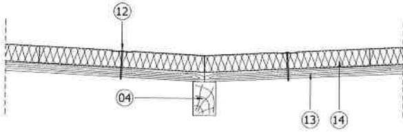
Le joint filant entre les panneaux Fesco C<sup>(14)</sup> est situé au droit d'un élément d'ossature principal ou secondaire<sup>(04)</sup>.
