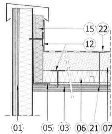
Le panneau vertical de la Gamme Fesco® non revêtu <sup>(15)</sup> d'épaisseur minimale 50 mm, est fixé mécaniquement <sup>(12)</sup> dans l'aile verticale de la costière métallique <sup>(05)</sup>.
