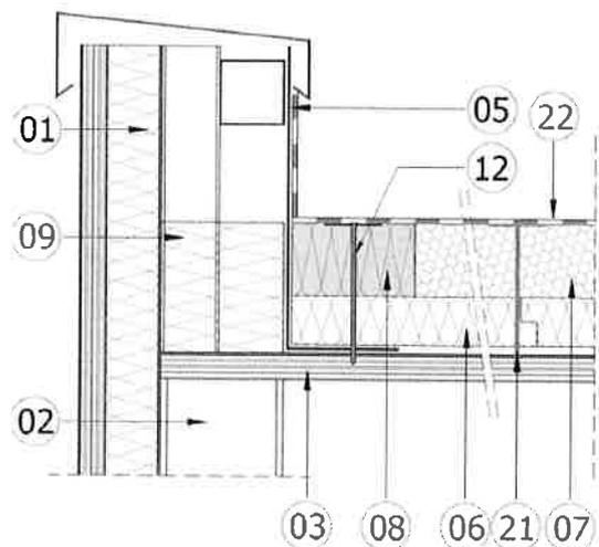
L'espace situé entre la costière métallique et la paroi verticale est comblé jusqu'au niveau supérieur du panneau KNAUF Therm TTI Se <sup>(07)</sup> par un isolant <sup>(09)</sup> de classe minimale A2-s2,d0.
