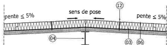
**Figure 3b – Raccordement des panneaux Fesco C-DO en faîtage et arêtier - appui simple**
