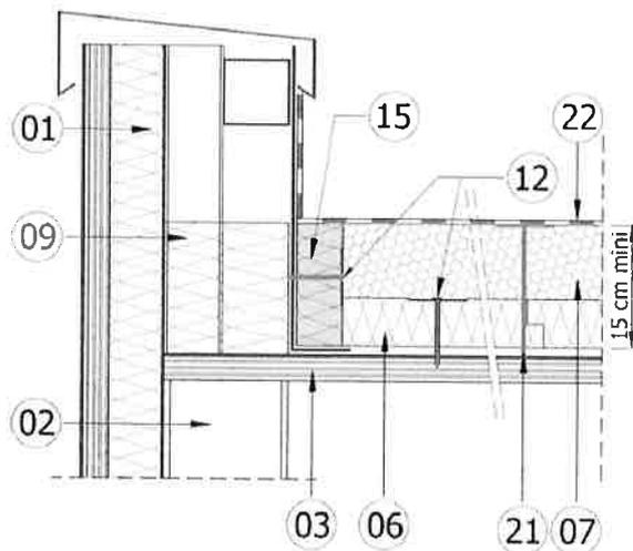
L'espace situé entre la costière métallique et la paroi verticale est comblé jusqu'au niveau supérieur du panneau KNAUF Therm TTI Se <sup>(07)</sup> par un isolant <sup>(09)</sup> de classe minimale A2-s2,d0.
