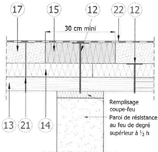
Le recouvrement est réalisé par un panneau de la Gamme Fesco® non revêtu <sup>(15)</sup> d'épaisseur égale à celle du lit supérieur en panneau KNAUF Therm TTI Se <sup>(17)</sup> et découpé sur une largeur minimale de 30 cm ; il est fixé mécaniquement dans l'élément porteur <sup>(13)</sup> à raison d'une fixation <sup>(12)</sup> par panneau isolant.
