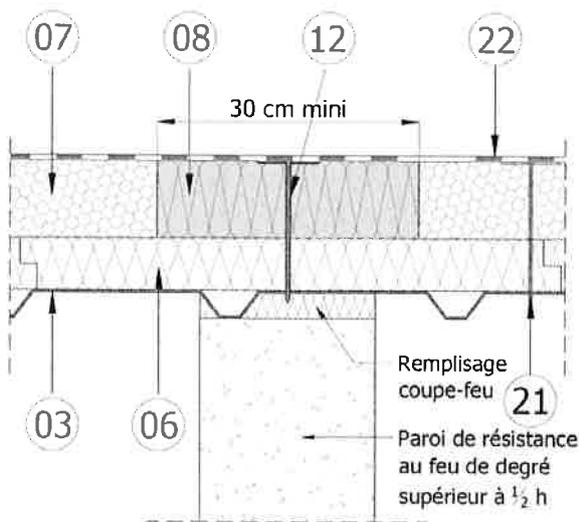
Le recouvrement est réalisé par un panneau de la Gamme Fesco® non revêtu <sup>(08)</sup> d'épaisseur égale à celle du lit supérieur en panneau KNAUF Therm TTI Se <sup>(07)</sup> et découpé sur une largeur minimale de 30 cm ; il est fixé mécaniquement dans l'élément porteur <sup>(03)</sup> à raison d'une fixation <sup>(12)</sup> par panneau.
