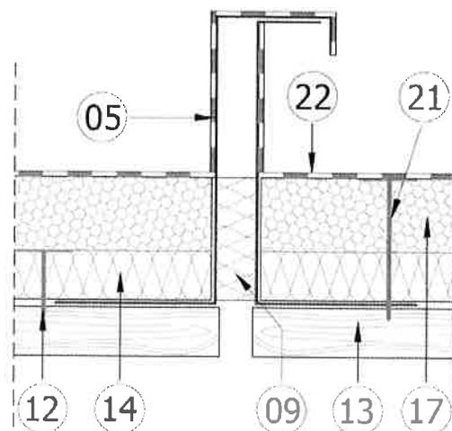
L'espace situé entre les deux costières métalliques est comblé par un isolant compressible<sup>(09)</sup> de classe minimale A2-s2,d0.
