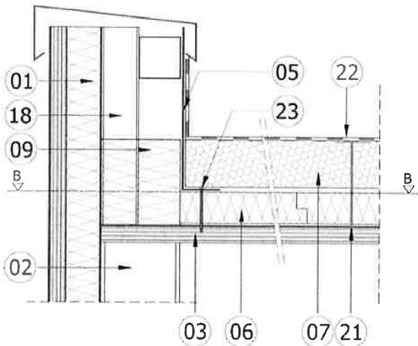
L'espace situé entre la costière métallique et la paroi verticale est comblé jusqu'au niveau supérieur du panneau KNAUF Therm TTI Se <sup>(07)</sup> par un isolant <sup>(09)</sup> de classe minimale A2-s2,d0.
