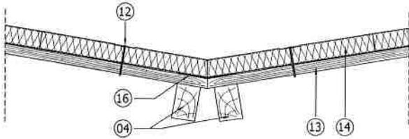
Une bande métallique<sup>(16)</sup> est placée et fixée au-dessus de l'élément porteur, sous le pare-vapeur, la mise en œuvre de cette bande métallique (quelle que soit la largeur du joint du joint des éléments à base de bois au faite ou en noue) est obligatoire sur deux appuis.
