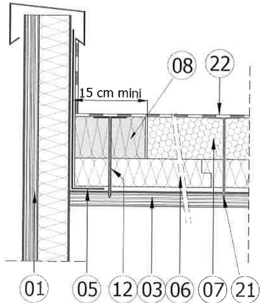
Le calfeutrement est réalisé par un panneau de la Gamme Fesco® non revêtu<sup>(08)</sup> d'épaisseur égale à celle du lit supérieur en panneau KNAUF Therm TTI Se<sup>(7)</sup> et découpé sur une largeur minimale de 15 cm ; il est fixé mécaniquement à l'élément porteur<sup>(05)</sup> à raison d'une fixation<sup>(12)</sup> par panneau.
