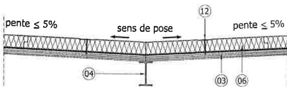
Le joint filant entre les panneaux Fesco C-DO (06) est situé au droit d'un élément d'ossature principal ou secondaire (04).
