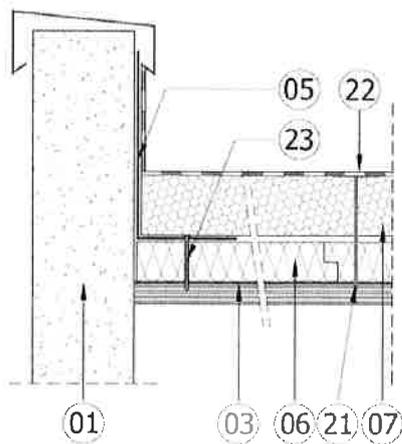
L'aile horizontale de la costière métallique <sup>(05)</sup> est placée au-dessus du panneau Fesco C-DO <sup>(06)</sup> formant écran thermique ; elle est fixée mécaniquement dans l'élément porteur <sup>(03)</sup> à l'aide de la fixation <sup>(23)</sup>. Le lit supérieur en panneau KNAUF Therm TTI Se <sup>(07)</sup> est en contact avec cette costière métallique.
