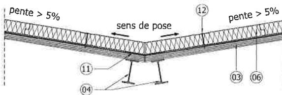
La mise en œuvre d'une tôle de liaison (10 - 11), quelle que soit la largeur du joint des éléments porteurs au faîte ou en noue, est obligatoire sur deux appuis selon le NF DTU 43.3 P1-1.
