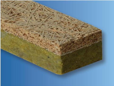
Les rupteurs de ponts thermiques Knauf Stop Therm F30 Longitudinaux (L) et Transversaux (T) sont des rupteurs rehaussés constitués d'un parement de Fibralth d'épaisseur 10 mm contrecollé sur une laine de roche d'épaisseur 40 mm.
