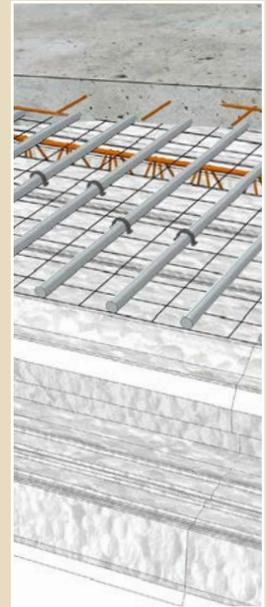
Détail de ferrailage des jonctions avec rupteurs gammes Knauf Stop Therm, Knauf RTK<sup>2</sup> et Knauf Pérïbreak :
