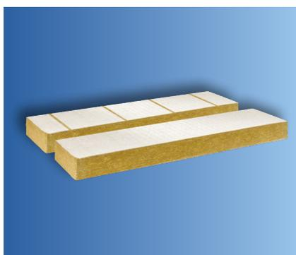
Bande de recouvrement en laine de roche pré-enduite utilisée comme protection incendie filante dans les systèmes d'Isolation Thermique des murs par l'Extérieur (ITE) recevant soit un enduit mince, soit un enduit épais. Elle répond aux critères de l'IT 249 (selon l'arrêté du 24 mai 2010) en tant que solution de protection P3, P4 et du Guide de Préconisations ETICS-PSE paru en avril 2016.
