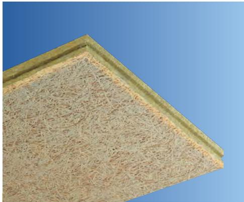
**Panneau composite constitué d'une âme en laine de roche de 35 mm contrecollée à deux parements de 10 et 5 mm en fibres longues de bois résineux sélectionnés, minéralisées et enrobées de ciment blanc. Le panneau apparent de 10 mm est feuilluré et biseauté sur les 4 cotés.**
