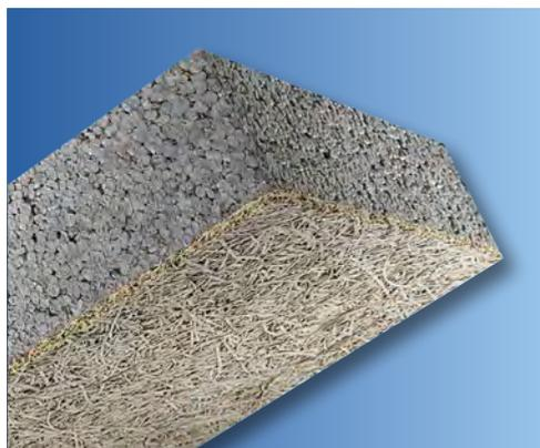
**Procédé d'isolation thermique en sous-face des planchers à l'aide de panneaux composites de laine de bois constitués d'une âme en PSE gris Knauf XTherm 32 SE et d'un parement de 5 mm en fibres longues de bois résineux sélectionnés, minéralisées et enrobées de ciment gris.**
