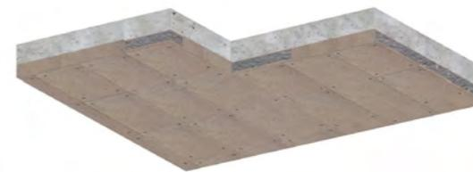
Fig. 11 : Protection des chants de l'isolant par un panneau Fibralth
