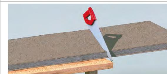
Fig. 19 : Découpe sur support plan
