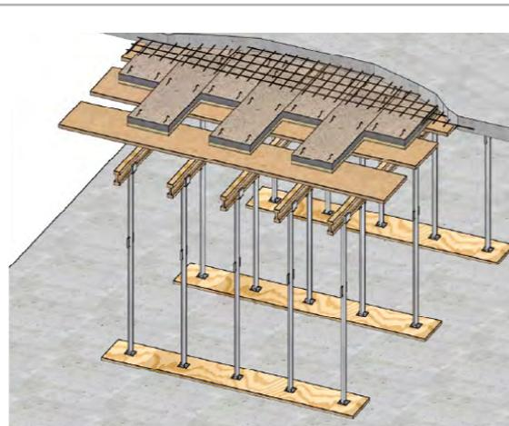
Fig.68 : Mise en place des panneaux en coffrage isolant traditionnel
