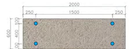
Emplacement des vis Knauf Spiradal à placer avant la pose des panneaux, en fond de coffrage.
