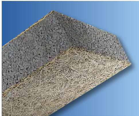
**Procédé d'isolation thermique en sous-face des planchers à l'aide de panneaux composites de laine de bois constitués d'une âme en PSE gris Knauf XTherm 32 SE et de 2 parements de 5 mm en fibres longues de bois résineux sélectionnés, minéralisés et enrobés de ciment gris.**
