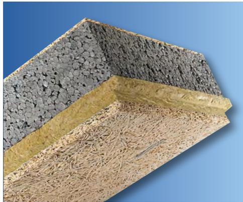
**Procédé d'isolation thermique en sous-face des planchers à l'aide de panneaux composites de laine de bois constitués d'une âme en laine de roche épaisseur 30 mm, d'un PSE Knauf XTherm ULTRA 31 SE Phonik et de deux parements de 20 et 5 mm en fibres longues de bois résineux sélectionnés, minéralisées et enrobées de ciment blanc. Le panneau apparent de 20 mm est feuilluré et biseauté sur les 4 côtés.**
