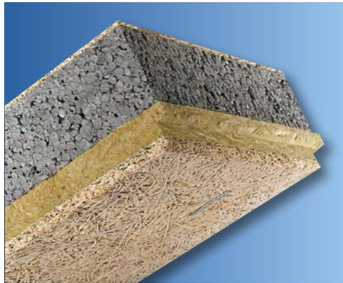
**Panneau composite constitué d'une âme en PSE gris XTherm ULTRA 32 SE, d'épaisseur variable, d'une couche de laine de roche de 30 mm et de 2 parements en laine de bois : 10 mm en face apparente et 5 mm en face coffrante. Le panneau est feuilluré et biseauté sur les 4 côtés.**
