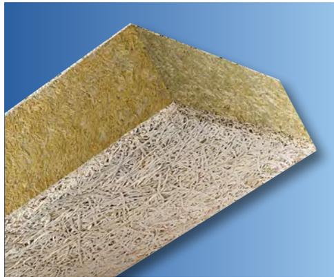
**Procédé d'isolation thermique en sous-face des planchers à l'aide de panneaux composites de laine de bois constitués d'une âme en laine de roche et de deux parements de 10 et 5 mm en fibres longues de bois résineux sélectionnés, minéralisées et enrobées de ciment blanc. Le parement apparent de 10 mm est biseauté sur les 4 côtés.**
