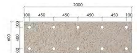
Emplacement des points de fixation par panneau (10 fixations)
