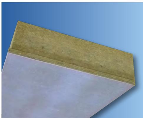
**Panneau composite constitué d'un parement lisse en bois-ciment de 10 mm contrecollé à un isolant en laine de roche. Le panneau apparent est feuilluré et biseauté sur les 4 côtés.**
