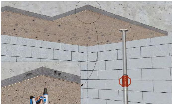
FM : Fixation mécanique
