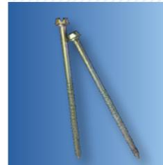
Vis à tête 6 pans Ø 8 mm constituée d'un filetage spécifique Ø 6,3 mm pour fixer les panneaux de laine de bois directement dans le béton.
