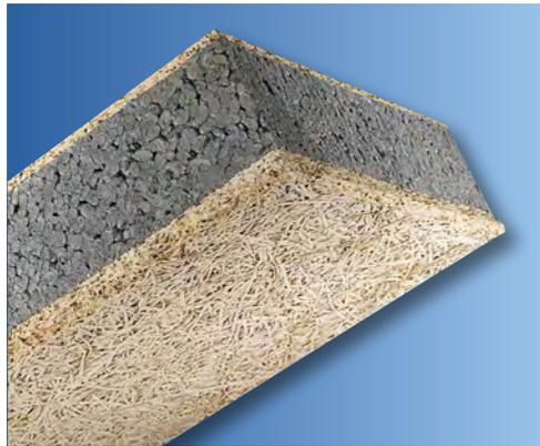
**Panneau composite constitué d'une âme en PSE gris élastifié Knauf XTherm 31 SE Phonik, d'un parement apparent de 20 mm biseauté sur les 4 côtés et d'un parement coffrant de 5 mm en fibres longues de bois résineux sélectionnés, minéralisées et enrobées de ciment blanc.**
