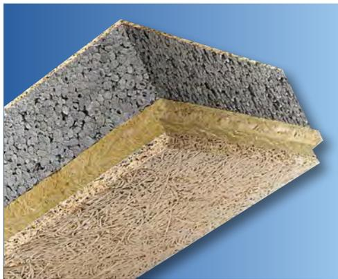
**Panneau composite constitué d'une âme en PSE gris Knauf XTherm ULTRA 31 SE Phonik, d'épaisseur variable, d'une couche de laine de roche de 30 mm et de 2 parements en laine de bois de 10 et 5 mm. Le panneau apparent de 10 mm est feuilluré et biseauté sur les 4 côtés.**
