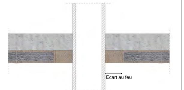
Fig. 12 : Passage du conduit de fumée
