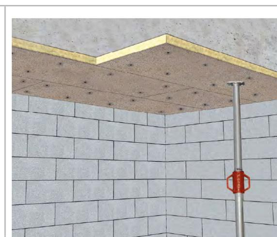
Fig. 14 : Mise en place et fixation des panneaux
