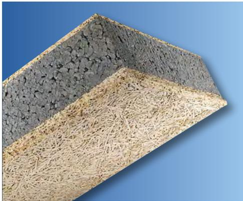
**Procédé d'isolation thermique en sous-face des planchers à l'aide de panneaux composites de laine de bois constitués d'une âme en PSE gris Knauf XTherm 32 SE et de deux parements de 20 et 5 mm en fibres longues de bois résineux sélectionnés, minéralisées et enrobées de ciment blanc. Le parement apparent de 20 mm est biseauté sur les 4 côtés.**
