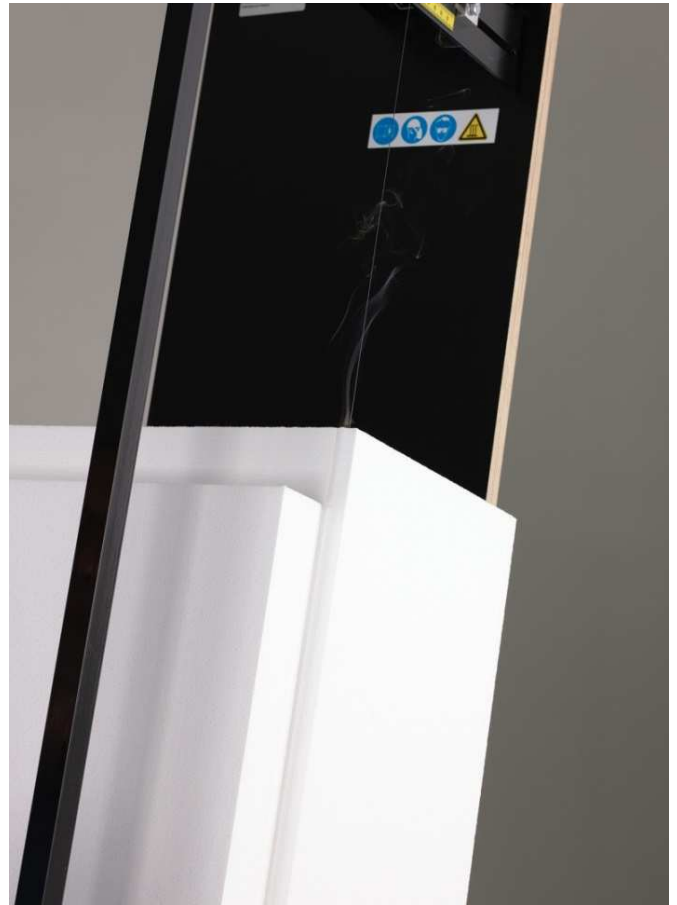
Réalisation de la feuilure à mi-épaisseur sur un panneau de K-FOAM
