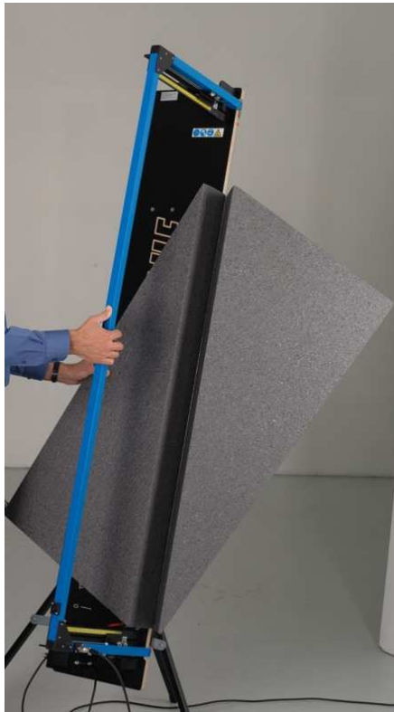
Coupe en diagonale d'un panneau de Knauf XTherm
