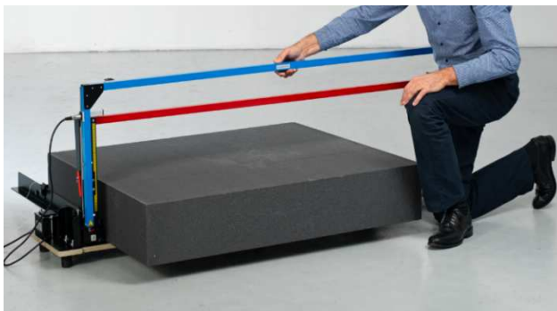
Coupe droite d'un panneau Knauf XTherm
