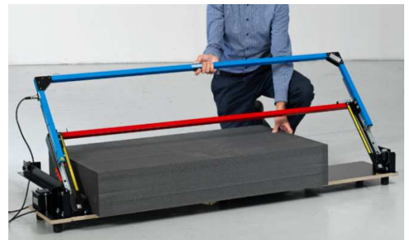
Coupe biaisée d'un panneau de Knauf XTherm
