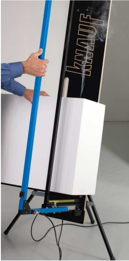
Coupe en diagonale d'un panneau de K-FOAM
