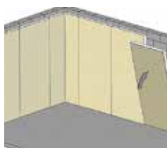
Fig. 1c : Application du panneau contre le support
