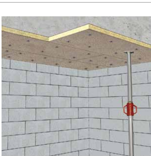
Fig. 14 : Mise en place et fixation des panneaux
