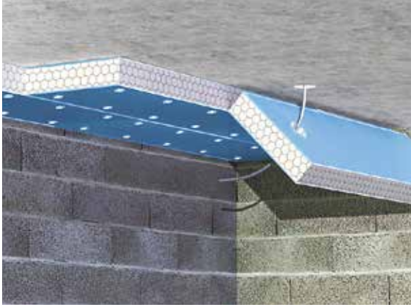
Fig. 15 : Découpe du panneau pour passage des canalisations ou gaines électriques
