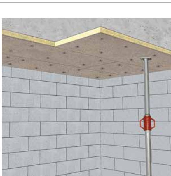
Fig. 14 : Mise en place et fixation des panneaux
