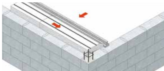
Fig. 3 : Serrage de la poutrelle précontrainte
