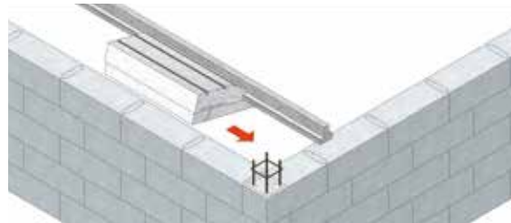
Fig. 2 : Pose du premier entrevous Hourdiversel
