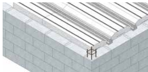
Fig. 4 : Pose des entrevous Hourdiversel
