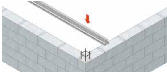
Fig. 1 : Pose de la poutrelle précontrainte
