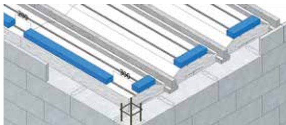
Fig. 5 : Pose des rupteurs
