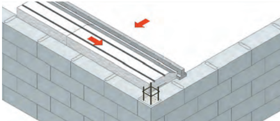
Fig. 3 : Serrage de la poutrelle précontrainte
