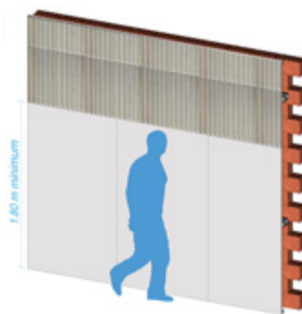
Pose murale avec dalles à la verticale à partir d'1,80 m
