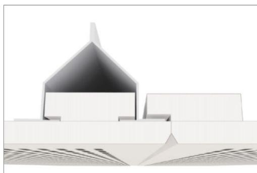
Dalle de plafond démontables Knauf Danoline - Décor Tangent Bord Corridor
