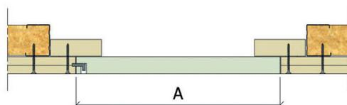
1 fermeture jusqu'à 600 mm
