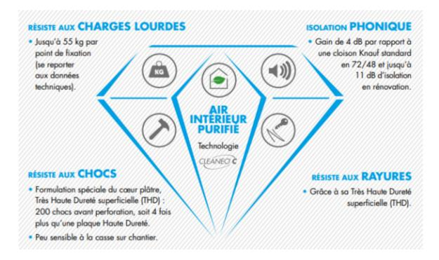
Cette plaque de plâtre peut être intégrée dans les cloisons de distribution ou les cloisons de séparation Knauf.
