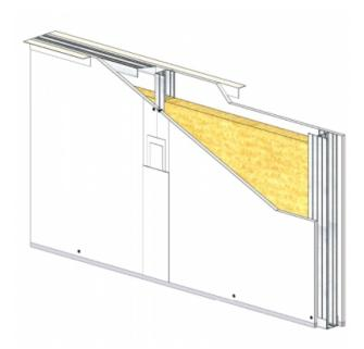
CLOISON DISTRIBUTIVE KM 72/48 - KNAUF KSB BA13 (SNOWBOARD) - 12,5 MM / 12,5 MM - EI 30 - 39 DB - 3,05M - MONTANT DOUBLE - ENTRAXE 600MM
