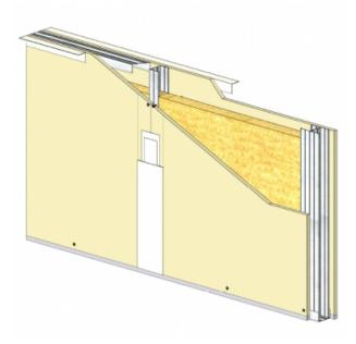
CLOISON DISTRIBUTIVE KM 100/70 - KNAUF KS BA15 (STANDARD) - 15 MM / 15 MM - EI 30 - 39 DB - 3,85M - MONTANT SIMPLE - ENTRAXE 400MM
