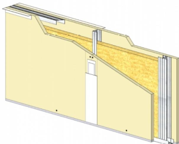
Les cloisons Knauf Métal sont constituées par assemblage d'une ou plusieurs plaques de parement en plâtre de la gamme Knauf, vissées sur une ossature métallique Knauf.
