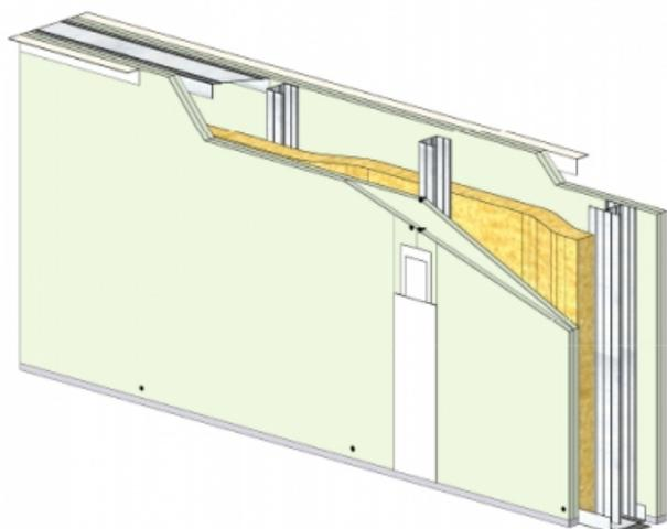
**Cloison séparative KMA 160/70 - KNAUF KH BA13 (HYDRO) - 2x 12,5 mm / 2x 12,5 mm - EI 60 - 59 dB - 3,75m - Montant double - Entraxe 400mm**
