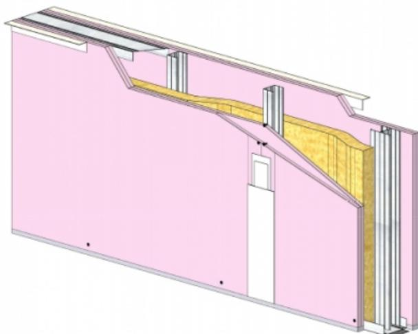
**Cloison séparative KMA 160/70 - KNAUF KF BA13 (FEU) + KNAUF KS BA13 (STANDARD) - 2x 12,5 mm / 2x 12,5 mm - EI 90 - 61 dB - 3,15m - Montant simple - Entraxe 400mm**
