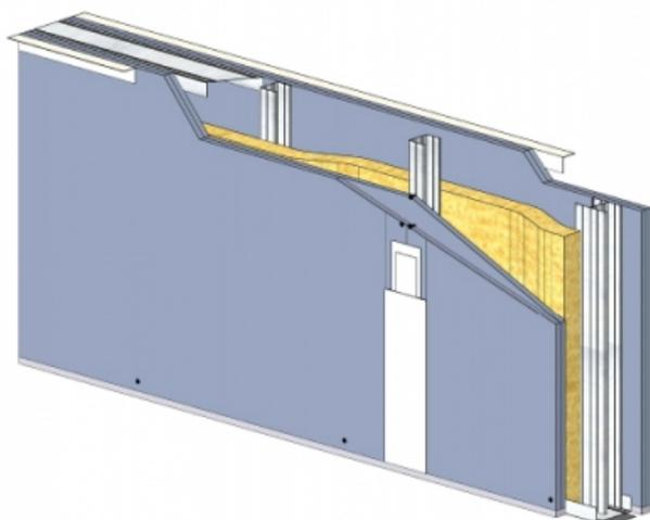
Cloison séparative constituée de parements en plaques de plâtre de la gamme Knauf vissés sur un double réseau d'ossatures en acier galvanisé, désolidarisé et composé de rails et montants.
