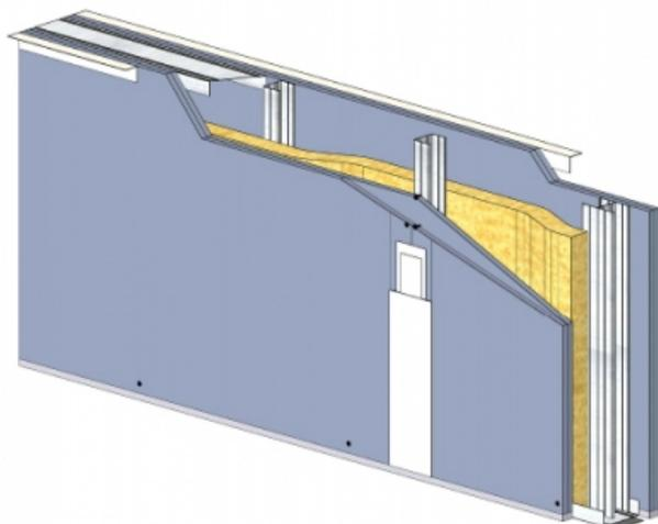
Cloison séparative constituée de parements en plaques de plâtre de la gamme Knauf vissés sur un double réseau d'ossatures en acier galvanisé, désolidarisé et composé de rails et montants.
