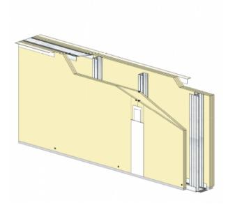
CLOISON SÉPARATIVE KMA 200/48 - KNAUF KS BA13 (STANDARD) - 3X 12,5 MM / 3X 12,5 MM - EI 60 - 64 DB - 3,4M - MONTANT DOUBLE - ENTRAXE 400MM
