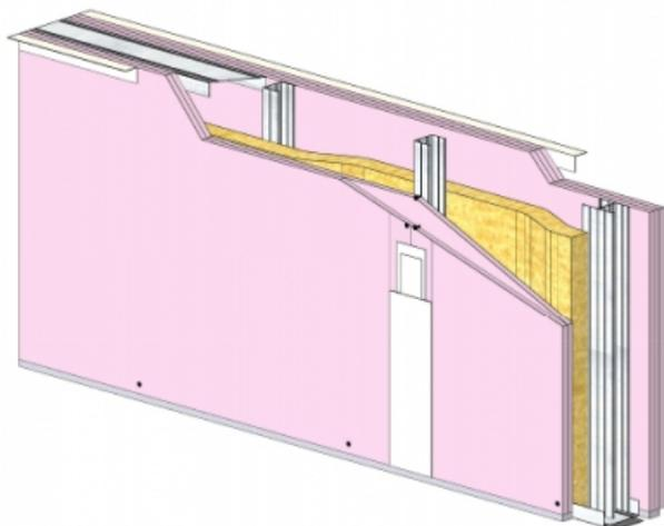
**Cloison séparative KMA 190/70 - KNAUF KF BA13 (FEU) + KNAUF KS BA13 (STANDARD) - 2x 12,5 mm / 3x 12,5 mm - EI 120 - 64 dB - 3,4m - Montant double - Entraxe 600mm**
