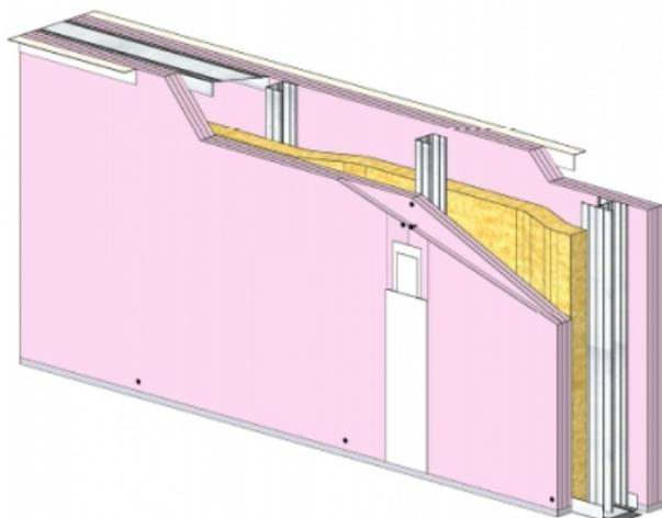
**Cloison séparative KMA 260/90 - KNAUF KF BA13 (FEU) + KNAUF KS BA13 (STANDARD) - 3x 12,5 mm / 3x 12,5 mm - EI 120 - 68 dB - 4,4m - Montant double - Entraxe 600mm**
