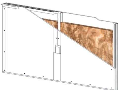
Les cloisons Knauf Métal sont constituées par assemblage d'une ou plusieurs plaques de parement en plâtre de la gamme Knauf, vissées sur une ossature métallique Knauf.
