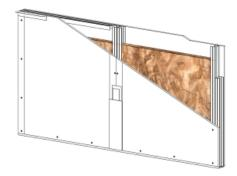
CLOISON DISTRIBUTIVE KM 84/48 - KNAUF HYDROPROOF BA18 (HYDRO) - 18 MM / 18 MM - EI 60 - 44 DB - 4,8M - MONTANT DOUBLE - ENTRAXE 450MM
