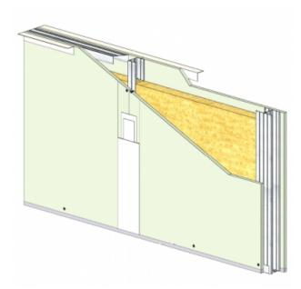
CLOISON DISTRIBUTIVE KM 72/48 - KNAUF KH BA13 (HYDRO) - 12,5 MM / 12,5 MM - EI 30 - 37 DB - 2,75M - MONTANT SIMPLE - ENTRAXE 400MM
