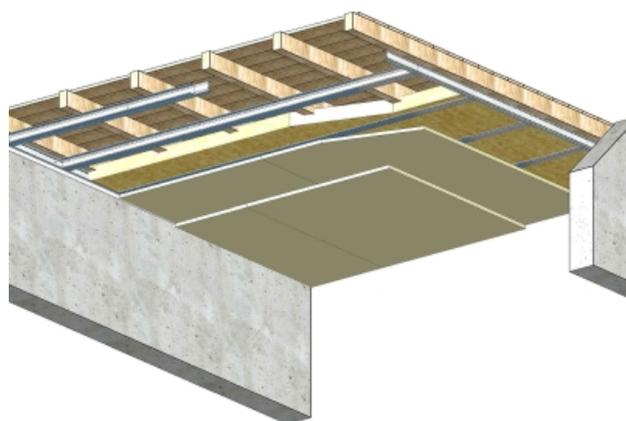
Plafond constitué par l'assemblage d'une ou plusieurs plaques de parement en plâtre, vissées sur une ossature métallique constituée de profilés F47 ou CD60 portés par des suspentes ou des montants autoportants. Le plafond en plaques de plâtre sur ossature tel que défini dans le DTU 25.41, contribue à la réduction de la perméabilité à l'air de l'enveloppe.
