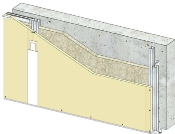
Contre-cloison constituée par l'assemblage d'une, deux ou trois plaques de parement en plâtre de la gamme Knauf vissées sur la même face d'une ossature en acier galvanisé composée de rails, montants et fourrures. Le DTU 25.41 révisé fait désormais une distinction entre locaux privatifs (locaux type A) et les autres locaux. Les ouvrages comportant un parement simple en BA 13 ou BA 15 ne sont admis que dans les locaux de type A.
