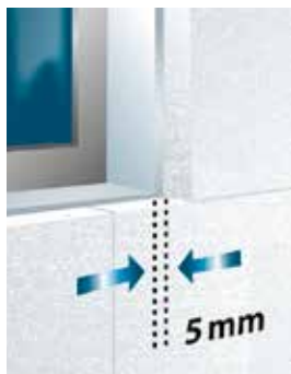
Fig. 7 : Désolidarisation du panneau au niveau des appuis de fenêtre
