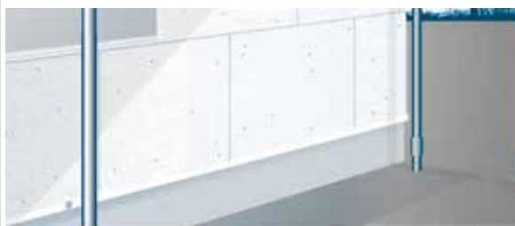
Fig. 4 : Pose des panneaux, façon "joint de pierre"
